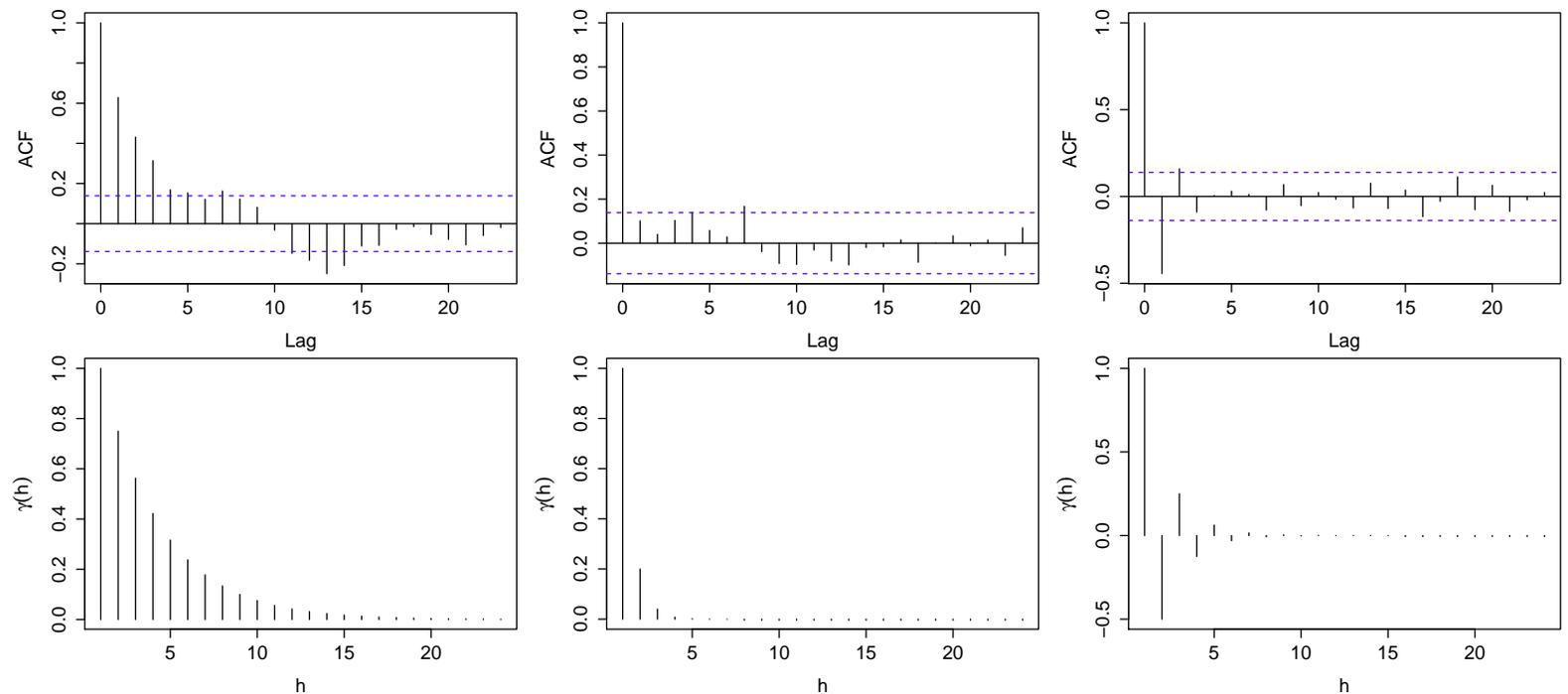
**Figure 9:** ACF d'AR(1) avec  $\alpha = 0.75, 0.2, -0.5$  (de gauche à droite). La ligne du haut est l'ACF estimé et celle du bas le théorique.
